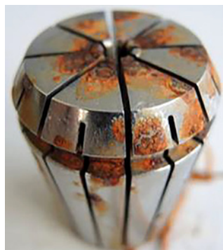
Competitor Stainless Steel ER Collet (Germany). Material: DIN 1.4034
